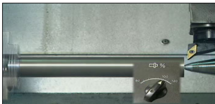
A fordulatszám növelésével nő az előtolósebesség és csökken a gépi főidő (021.wmv)
