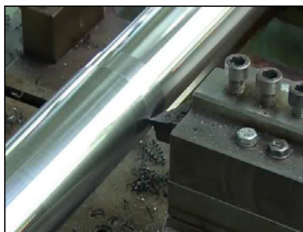
Szárazmegmunkálás, minimálkenés, árasztásos hűtés (020.wmv)
