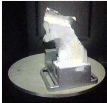
A digitalizálni kívánt fegyvermarkolat készülékbe fogva a szkennер asztalán.
