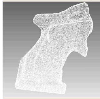
Szkennер által készített pontfelhő.
