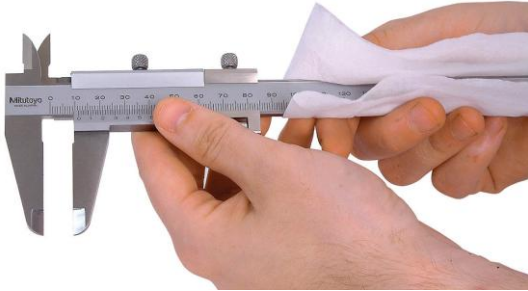
7.2.15 ábra Tolómérce tisztítása []
