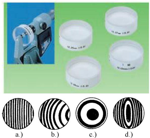
7.2.23 ábra Optikai síküveg a mérőfelület vizsgálatához []
