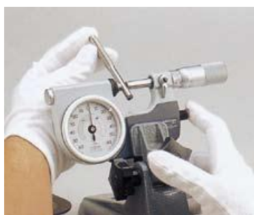
7.2.30 ábra Kengyeles mikrométer használata www.uni-max.hu , www.photaki.de
