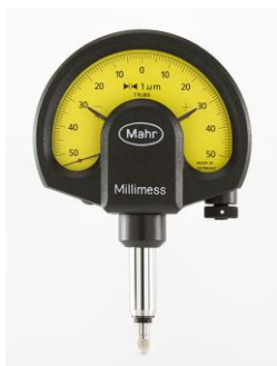
7.2.48 ábra Ma használatos orthotest rendszerű finomtapintó képe
