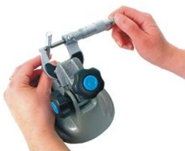
7.2.30 ábra Kengyeles mikrométer használata www.uni-max.hu , www.photaki.de
