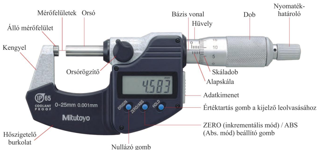
7.2.21 ábra Digitális mikrométer fő részei []
