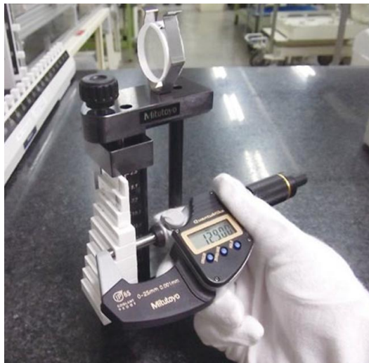
7.2.29 ábra MÉRŐHASÁBBEFOGÓ TARTOZÉK MIKROMÉTER KALIBRÁLÁSHOZ []
