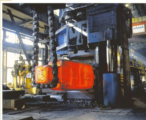
Bild 5.7: Schmiedung eines 100-Tonnen-Blockes unter der 55 MN-Schmiedepresse
