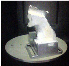
A digitalizálni kívánt fegyvermarkolat készülékbe fogva a szkennert asztalán.
