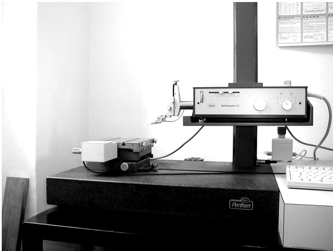
6.20. ábra Állványos profilometriás érdességmérő
