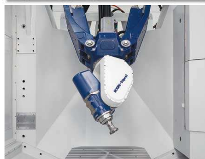
Parallel kinematikájú gép Gyors mozgások Kis munkatér
