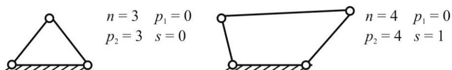
9.4. ábra. Néhány jellemző kinematikai pár felépítése és jelölése
