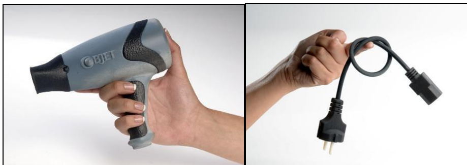
15.21. ábra. PolyJet eljárással készített több komponensű és rugalmas prototípus
