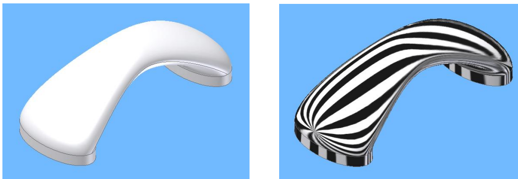
4.27. ábra. Pásztázással létrehozott bútorfogantyú, és a felület zebracsíkos esztétikai vizsgálata
