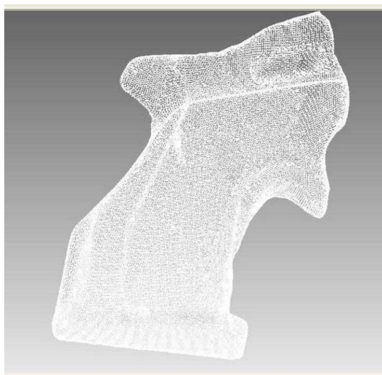
15.2. ábra. Munkadarabról készített pontfelhő PIXFORM programban
