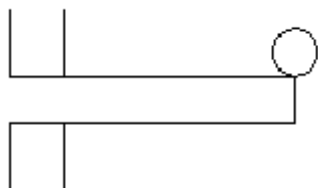
5.11. ábra. Fix befogás az egyik végén és terhelés a másikon.
