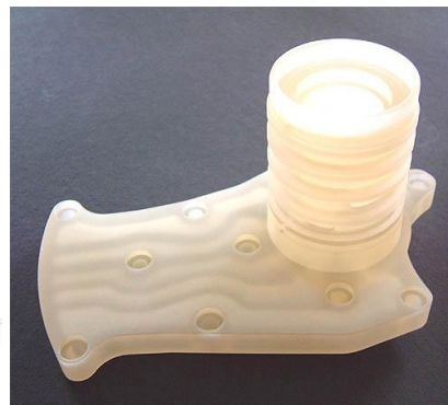
15.13. ábra. Sztereolitográfia A) Működési elv, B) Mintadarab
