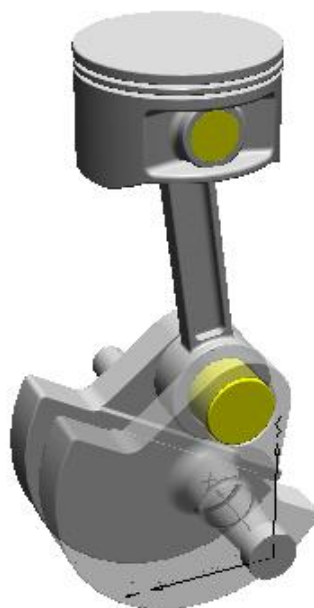
9.7. ábra. CAD modellből felépített forgattyús hajtómű
