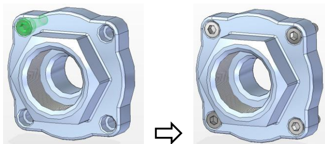
8.18. ábra. Egy alkatrész (csavar) kör, furatmintába kiosztása
