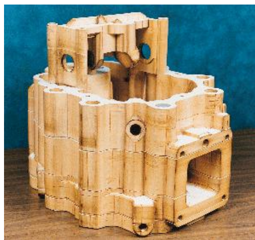
15.16. ábra. Rétegelt darab gyártás A) Működési elv, B) Mintadarab
