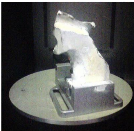
15.1. ábra. Szkennelni kívánt munkadarab (sportpisztoly markolat)
