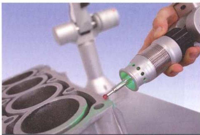
Munkadarab letapogatása kézi eszközzel
