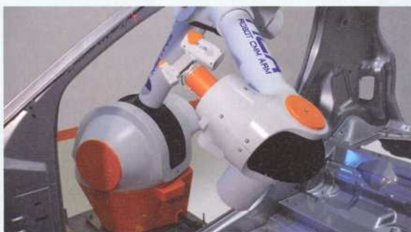
A világ első mérőrobotjával, a Metris RCA rendszerrel zajlik a Daimler Chrysler Smart gépkocsijainak teljes ellenőrzése, 100 százalékban automatikusan. A szkennelőrobot 4,5 m-es sugarú körben képes kinyúlni és 360×180 fokos térbeli félgömbön mozog. Ez korábban nem volt lehetséges a robotok pontatlansága miatt.
