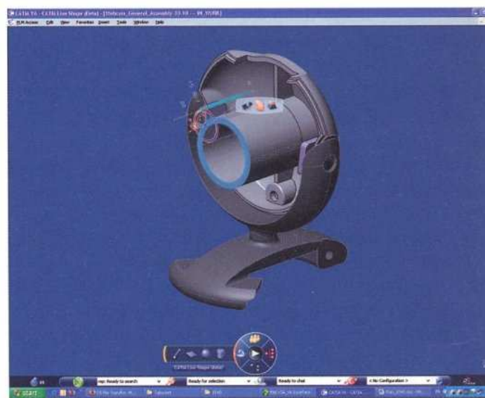
Gyorsan elsajátítható egyszerű modellezési eljárásokkal lehetőség van 3D-s modellek létrehozására a „nézegetőben”. Az információcseré tervezőrendszer-függetlenül, közvetlen a 3D-ben történik, leegyszerűsítve a kommunikációs utakat
