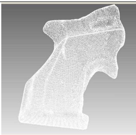
15.2. ábra Munkadarabról készített pontfelhő PIXFORM programban
