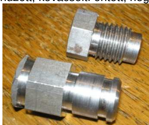
Húzott rúdból esztergált alkatrészek
