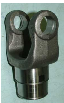
Süllyesztékes kovácsolással előállított acél alkatrész
